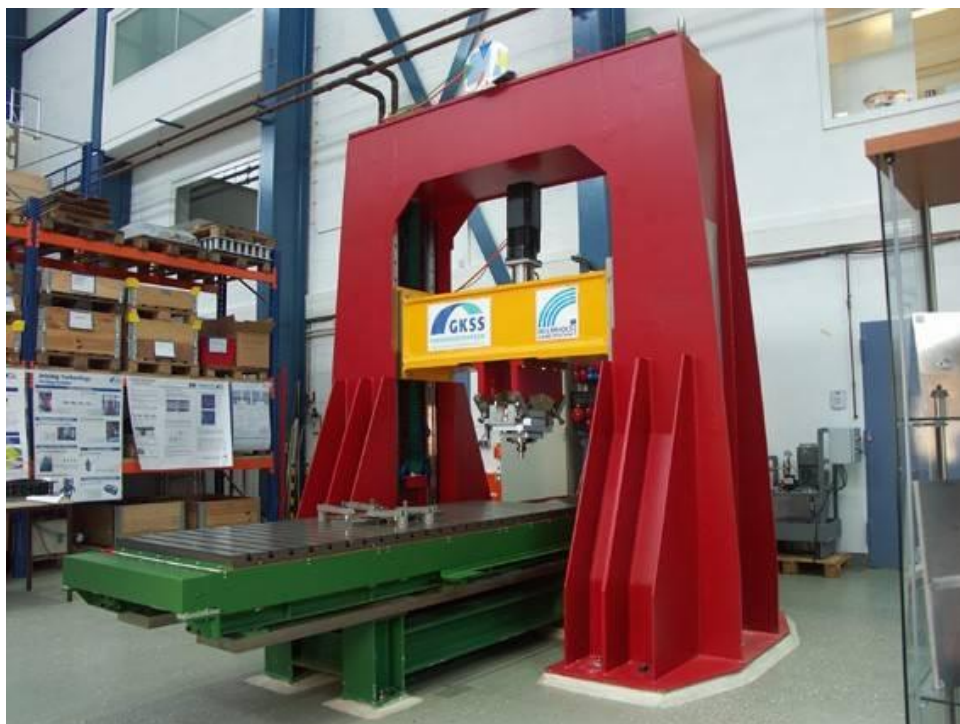
Figura 3: Equipamento utilizado para a soldagem das amostras.
