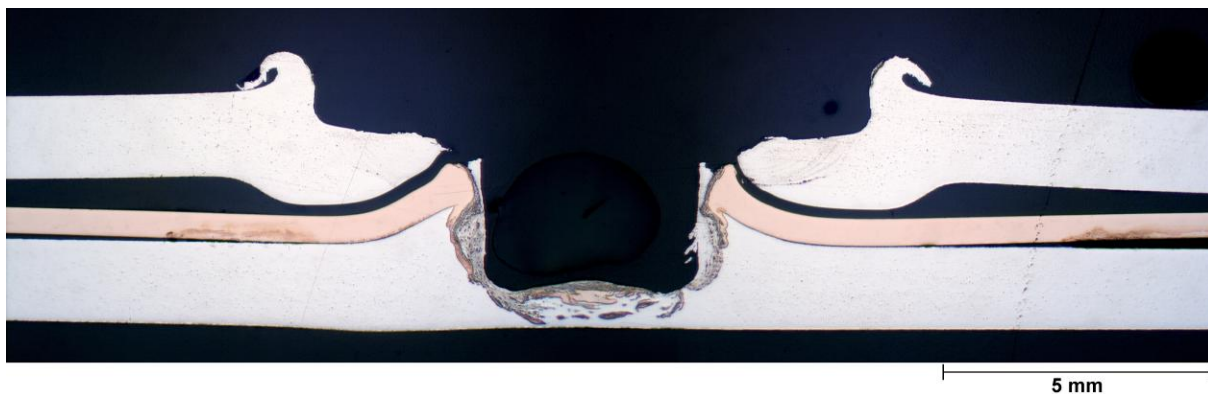
Figura 6: Material soldado para caracterização do fluxo de material.
