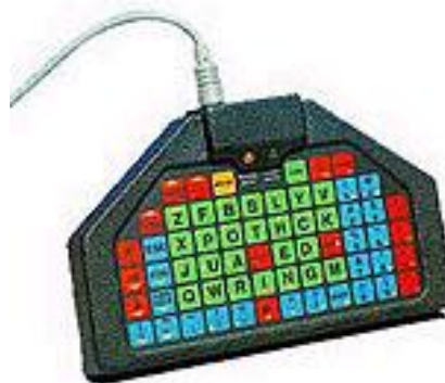
Figura 2: Teclado em escala reduzida para ser utilizado com apenas uma mão.
