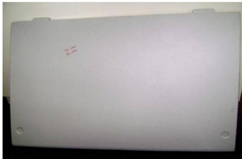
Figura 3: Primeira peça protótipo preparada na empresa Marcopolo com manta de sisal modificada em matriz poliéster
